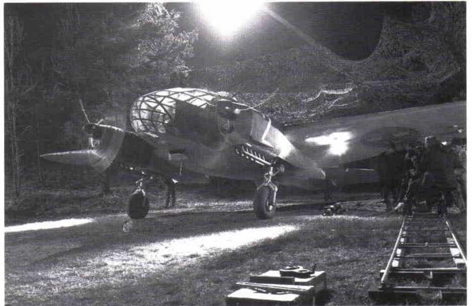
– Tystnad! Klappa! Tagning! Börja! En repetitionsscen när S16 Caproni startar från ett värn på natten. Fotografen Jan-Hugo Norman åker med på den utlagda rälsen. Planets elmotorer kan inte driva originalpropellrarna, som ersatts med aluminiumrör och ger god visuell effekt.
